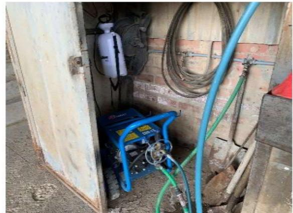
El equipo de lavado suministra un caudal comprendido entre los 15 y los 17 l/min, por lo que los vertidos del lavadero no son superiores a 1 m<sup>3</sup>/hora, con una utilización diaria comprendida entre las 3 y las 6 horas, dependiendo fundamentalmente de las condiciones climáticas y el empleo de los vehículos y la maquinaria.
