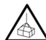
RIESGO CARGAS SUSPENDIDAS
