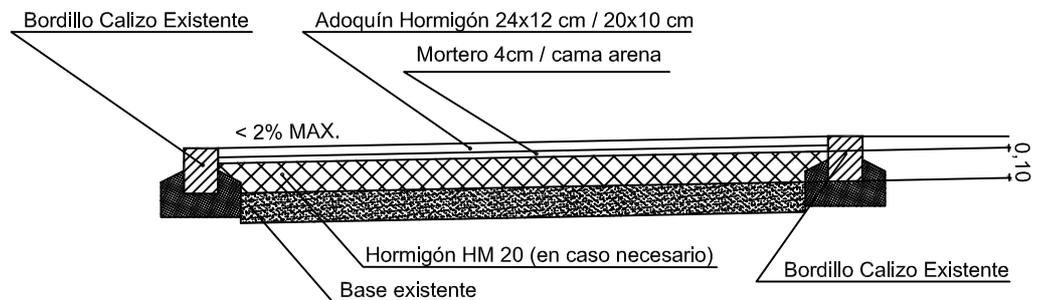
DETALLE DE: SECCIONES TIPO.
