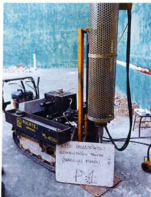
ENSAYO DE PENETRACION DINAMICA TIPO D.P.S.H. Nº 1.
