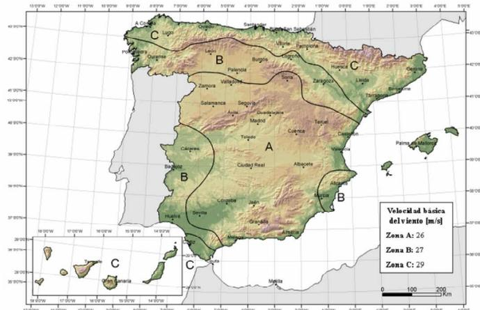
Figura D.1 Valor básico de la velocidad del viento,  $v_0$
