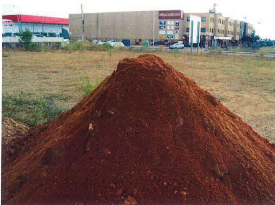
CALICATA C-1. MATERIAL EXTRAIDO.
