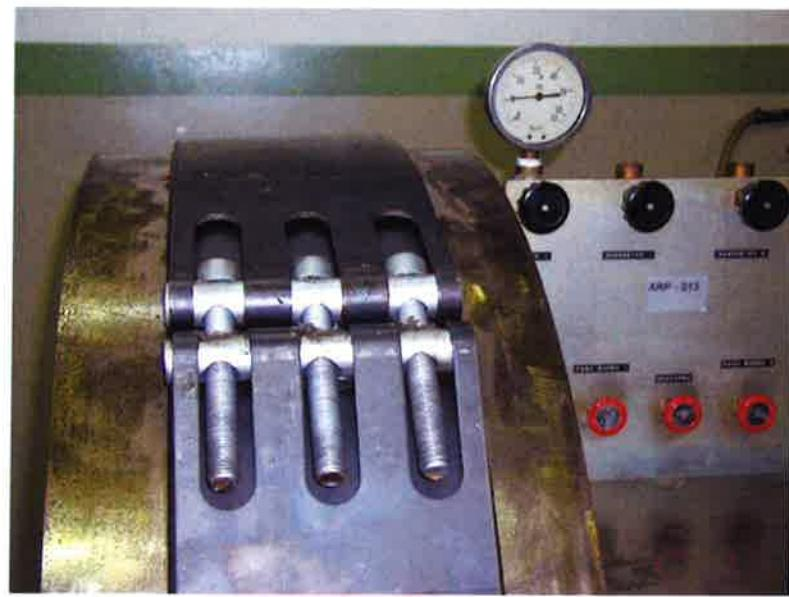
Fleje de 4 mm de espesor adaptado a la contracurva
