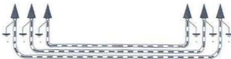
Como condiciones de instalación preferentes, se colocarán los cables al tresbolillo y lo más juntos posibles para que reduzca la tensión inducida en la pantalla y, por tanto, la corriente de circulación.
