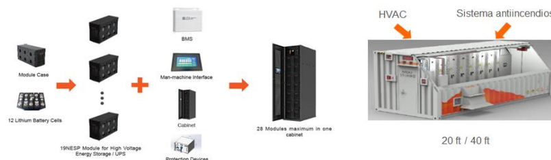
Figura 2: Configuración interior de los sistemas de baterías.
