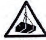
SA - 04 RIESGO CARGAS SUSPENDIDAS
